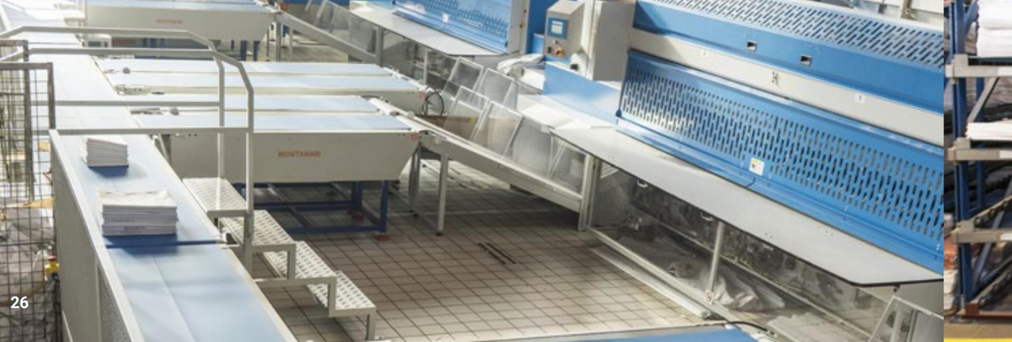
**Magazzino dinamico** — La biancheria confezionata può essere immagazzinata manualmente o automaticamente attraverso un magazzino dinamico dove, una serie di rulliere appositamente progettate, stoccano la biancheria prima della spedizione presso i clienti.
